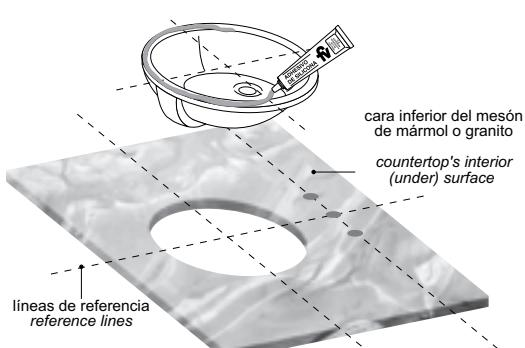
B4- Se recomienda fijar el lavabo previo a la colocación del mesón, pudiendo ser realizado en el piso "boca abajo" y trabajar con el propio peso del lavabo las 24 horas necesarias para poder ser utilizado.
