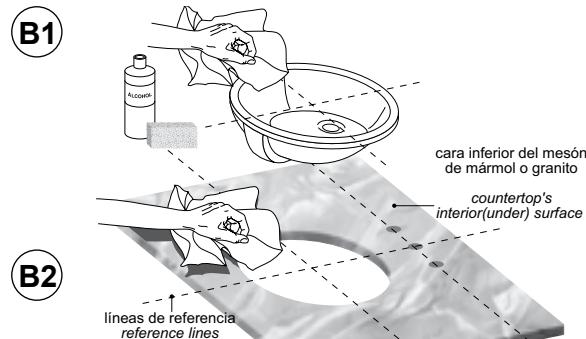
B3- Aplicar el adhesivo de silicona en todo el contorno del lavabo, colocarlo sobre el mesón de mármol o granito en la posición final donde será instalado y mantenerlo presionado durante un minuto.
